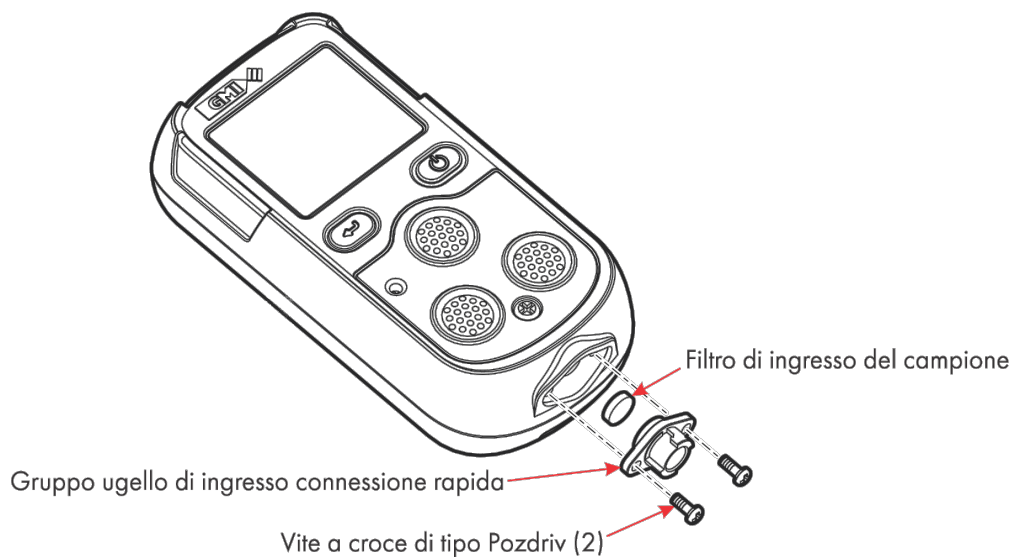
Figure 53: Sostituzione del filtro di ingresso del campione (polvere)
