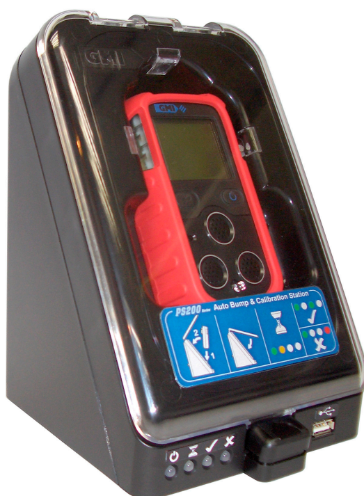
Slika 25: Samodejna postaja za preizkus in umerjanje PS200
