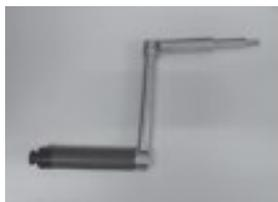
Figure 44. Manivelle de débrogage
