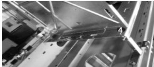
Figure 24. Tablette à clipser telle qu'installée
