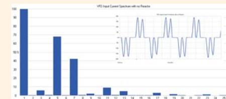
Forme d'onde et spectre du courant d'entrée d'un VV sans bobine de réactance.
