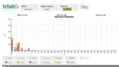
Utilisez le filtre LINEATOR là où des variateurs de vitesse et des redresseurs à six impulsions sont employés.
