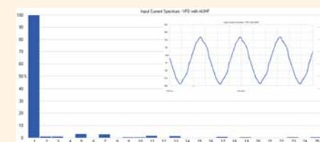
Forme d'onde et spectre du courant d'entrée d'un VV avec filtre AUHF LINEATOR.
